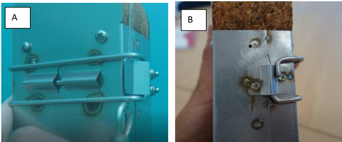
Figure 6 : (A) Avançon mal bloqué dans la pince (b) Pince fragilisée au cours de tests
