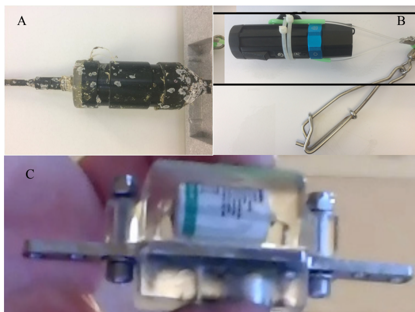
Fig. 2. Photographies d'un hydrophone ST300HF 200 mm L x 60 mm D (A), de la camera PARLENZ 116 mm L x 38 mm D avec son gréement (snap) (B) et d'un accéléromètre DEEPG+ (C).
