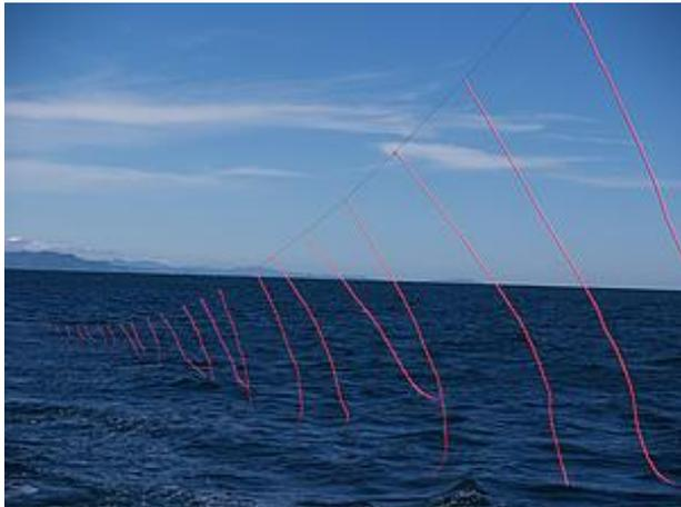
Figure 10 : Tori line tracté à l'arrière du bateau pour effaroucher les oiseaux de mer attaquant les appâts, © Seafood New Zealand
