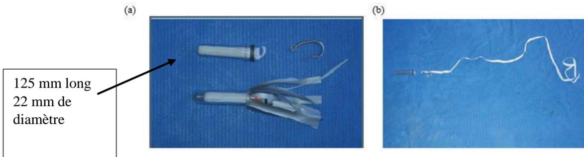
***Figure 53 : (a), dispositif ruban de clôture électrique en position de repos, (b) dispositif déployé (McPherson, et al., 2010)***
