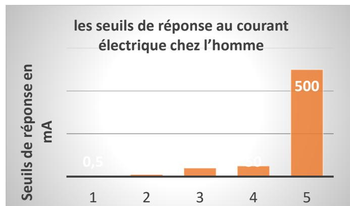
***Figure 41 : Les seuils de réponse au courant électrique chez l'homme***
