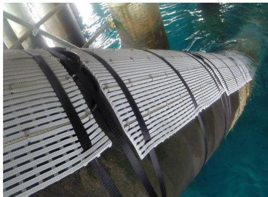
**Figure 44 : Matériels de dissuasion électrique pour les otaries**
