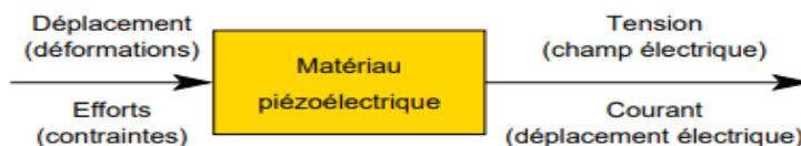
**Figure 47 : Effet piézoélectrique direct.**
